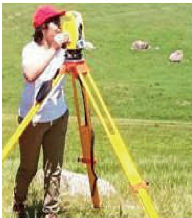
*Рис.5. Электронный тахеометр*
